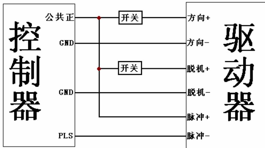
2. 与DY-I型智能单轴控制器的连接方法
