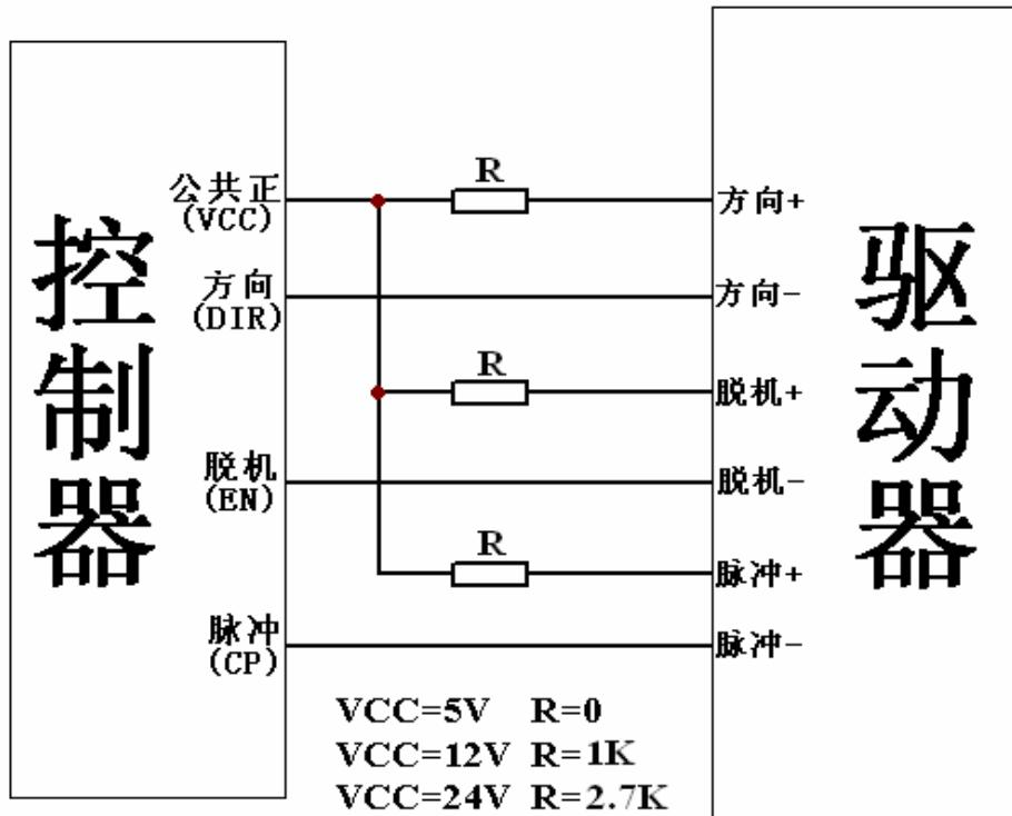
R为串联限压电阻，当控制器的接口电压为5V时，无需R，直连既可；当接口电压为12V时，请串联1K电阻；当接口电压为24V时，请串联2.7K电阻（后同）。
