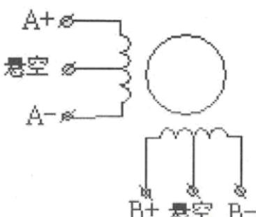
4相6线电机可以和驱动器相连，中间抽头的两线悬空不接
