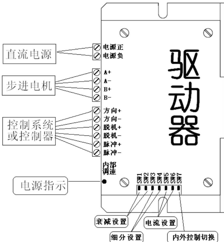
注：SW7为ON时，内部电位器调速控制，此时请勿外接脉冲
