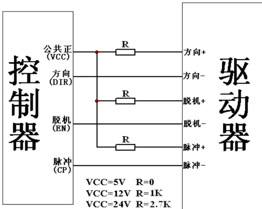
R为串联限压电阻，当控制器的接口电压为5V时，无需R，直连既可；当接口电压为12V时，请串联1K电阻；当接口电压为24V时，请串联2.7K电阻(后同)。
