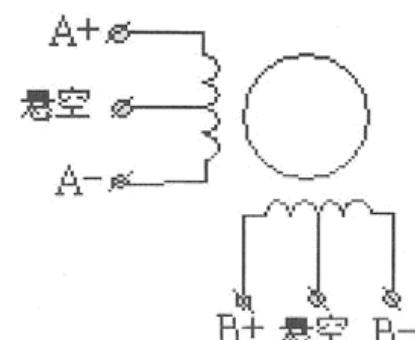
4相6线电机可以和驱动器相连，中间抽头的两线悬空不接
