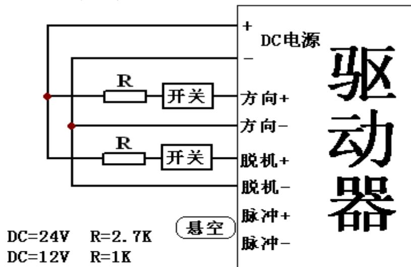
2. 外部脉冲控制，与DY-I型智能单轴控制器的连接方法
